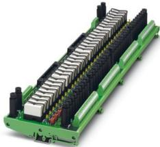
32-kanaliges Eingabe-Relaismodul (1 Schließerkontakt) mit Schraubanschluss und Sicherung (1 A). I/O-Anschluss redundant ausgeführt sind Spannungseinspeisung und 50-polige Leiste. Geeignet für die Yokogawa Karte ADV151 und ADV161.
