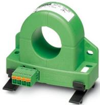
Universalstrommessumformer, zur Messung von Gleich-, Wechsel- und verzerrten Strömen, Eingangsstrom 0 ... 100 A, Ausgang 4 ... 20 mA
