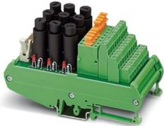
VARIOFACE-Modul, für 8 Kanäle mit zusätzlichen Plus und Minus Klemmen. Jeder Kanal wird über eine Sicherung (5 x 20 mm) abgesichert und verfügt über eine Sicherungsausfallanzeige. Über ein Trennmesser kann der Signalpfad unterbrochen werden.
