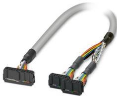
Konfektioniertes Rundkabel; Anschluss 1: IDC/FLK-Buchsenleiste (1x 20-polig); Anschluss 2: IDC/FLK-Buchsenleiste (2x 14-polig); Kabellänge: 0,5 m
