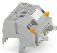
V8-Adapter für 8 x PLC-INTERFACE (6,2 mm), Steuerung: SPS-Systemverkabelung von Eingangskarten, Anschluss 1: IDC/FLK-Stiftleiste 1x 14-polig, Anschluss 2: Steckanschluss (Aufrastbar auf 8x PLC-INTERFACE-Klemmen), Anschluss 3: Schraubanschluss 1x 2-polig, Anzahl der Kanäle: 8, Ansteuerlogik: minusschaltend
