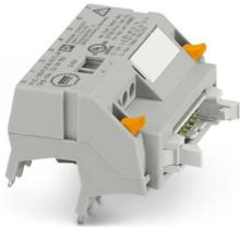
V8-Adapter für 8 x PLC-INTERFACE (6,2 mm), Steuerung: SPS-Systemverkabelung von Ausgangskarten, Anschluss 1: IDC/FLK-Stiftleiste 1x 14-polig, Anschluss 2: Steckanschluss (Aufrastbar auf 8x PLC-INTERFACE-Klemmen), Anschluss 3: Schraubanschluss 1x 2-polig, Anzahl der Kanäle: 8, Ansteuerlogik: minusschaltend
