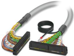
Konfektioniertes, geschirmtes Rundkabel; Anschluss 1: IDC/FLK-Buchsenleiste (1x 50-polig); Anschluss 2: IDC/FLK-Buchsenleiste (1x 50-polig) (Das Schirmgeflecht ist auf ein separates Kabelende herausgeführt.); Kabellänge: 4 m
