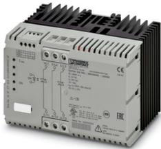
3-phasiges Halbleiterschütz mit 24 V DC Eingang, 37 A Ausgangsstrom, Nullspannungsschalter, optional mit Thermosicherung
