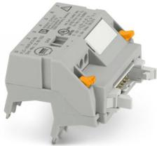
V8-Adapter für 8 x PLC-INTERFACE (6,2 mm), Steuerung: SPS-Systemverkabelung von Eingangskarten, Anschluss 1: IDC/FLK-Stiftleiste 1x 14-polig, Anschluss 2: Steckanschluss (Aufrastbar auf 8x PLC-INTERFACE-Klemmen), Anschluss 3: Schraubanschluss 1x 2-polig, Anzahl der Kanäle: 8, Ansteuerlogik: plusschaltend
