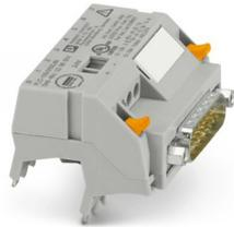
V8-Adapter für 8 x PLC-INTERFACE (6,2 mm), Steuerung: SPS-Systemverkabelung von Eingangskarten, Anschluss 1: D-SUB-Stiftleiste 1x 15-polig, Anschluss 2: Steckanschluss (Aufrastbar auf 8x PLC-INTERFACE-Klemmen), Anschluss 3: Schraubanschluss 1x 2-polig, Anzahl der Kanäle: 8, Ansteuerlogik: plusschaltend
