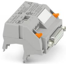
V8-Adapter für 8 x PLC-INTERFACE (6,2 mm), Steuerung: SPS-Systemverkabelung von Ausgangskarten, Anschluss 1: D-SUB-Buchsenleiste 1x 15-polig, Anschluss 2: Steckanschluss (Aufrastbar auf 8x PLC-INTERFACE-Klemmen), Anschluss 3: Schraubanschluss 1x 2-polig, Anzahl der Kanäle: 8, Ansteuerlogik: plusschaltend
