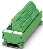
VARIOFACE-Modul, mit Zugfederanschluss und D-Subminiatur-Stiftleiste, zur Montage auf NS 35/7,5, Polzahl 37
