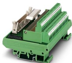
VARIOFACE-Modul, mit Schraubanschluss und Flachbandkabel-Steckverbinder, zur Montage auf NS 32 oder NS 35/7,5, mit Stiftleiste sowie kurzen und langen Verriegelungsklinken für Federleisten, Polzahl 40, mit Leuchtanzeige
