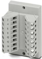
Das VARIOFACE-Durchführungsmodul realisiert eine 1:1-Verbindung zwischen Schraubanschlussklemmen und einer IDC / FLK - Stiftleiste (2,54 mm, Polzahl 16).
