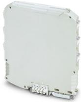
Tragschienengehäuse, Komplettgehäuse mit Metallfußriegel, hohe Bauform, mit TBUS-Option, mit Lüftungsschlitzen, Breite: 12,6 mm, Höhe: 99 mm, Tiefe: 113,65 mm, Farbe: lichtgrau (ähnlich RAL 7035), Querverbindung: Tragschienen-Busverbinder (optional), Polzahl Querverbinder: 5
