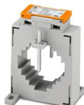
Aufsteckstromwandler, Primärstrom 500 A AC; Sekundärstrom 5 A AC; Genauigkeitsklasse 1; Bemessungsleistung 5 VA
