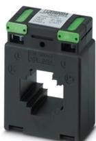
Aufsteckstromwandler, Primärstrom 150 A AC; Sekundärstrom 5 A AC; Genauigkeitsklasse 1; Bemessungsleistung 3,75 VA
