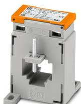
Aufsteckstromwandler, Primärstrom 60 A AC; Sekundärstrom 5 A AC; Genauigkeitsklasse 1; Bemessungsleistung 1,25 VA
