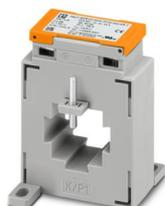
Aufsteckstromwandler, Primärstrom 600 A AC; Sekundärstrom 5 A AC; Genauigkeitsklasse 1; Bemessungsleistung 10 VA
