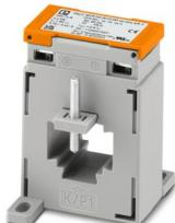
Aufsteckstromwandler, Primärstrom 150 A AC; Sekundärstrom 5 A AC; Genauigkeitsklasse 1;
