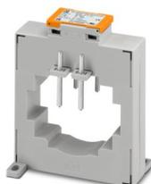
Aufsteckstromwandler, Primärstrom 2500 A AC; Sekundärstrom 5 A AC; Genauigkeitsklasse 1; Bemessungsleistung 15 VA
