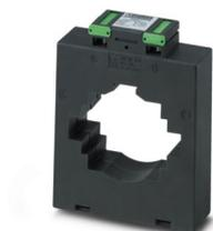
Aufsteckstromwandler, Primärstrom 400 A AC; Sekundärstrom 5 A AC; Genauigkeitsklasse 1; Bemessungsleistung 7,5 VA
