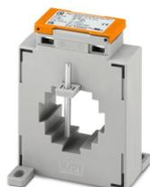
Aufsteckstromwandler, Primärstrom 300 A AC; Sekundärstrom 5 A AC; Genauigkeitsklasse 1; Bemessungsleistung 10 VA
