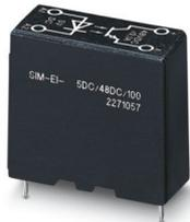
Eingabe-Solid-State-Relais, mit Schutzbeschaltung im Ein- und Ausgangskreis, Eingang: 24 V DC, Ausgang: 8 - 48 V DC/100 mA
