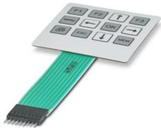
Folientastatur selbstklebend, Silberleittechnik, 12 Tasten hochgeprägt, 3 Farben, Anschlusskabel: 100,5 mm, mit Crimp-Buchse female Rastermaß: 2,54 mm, Einsatztemperatur: -20 °C ... 70 °C
