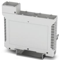
Tragschienengehäuse, Gehäuseunterteil mit Metallfußriegel, für Busverbinder 10/10, Breite: 39,7 mm, Höhe: 180,1 mm, Tiefe: 137,7 mm, Farbe: lichtgrau (ähnlich RAL 7035), Querverbindung: Tragschienen-Busverbinder (optional), Polzahl Querverbinder: 10
