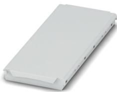
Tragschienengehäuse für den Einsatz in Installationsverteilern nach DIN 43880, Rastdeckel (unlösbar), Breite: 107,6 mm, Höhe: 45 mm, Tiefe: 8 mm, Farbe: lichtgrau (ähnlich RAL 7035)
