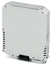
Tragschienengehäuse, Komplettgehäuse mit Metallfußriegel, hohe Bauform, mit Lüftungsschlitzen, Breite: 22,6 mm, Höhe: 99 mm, Tiefe: 113,65 mm, Farbe: lichtgrau (ähnlich RAL 7035), Querverbindung: Tragschienen-Busverbinder (optional), Polzahl Querverbinder: 5
