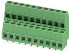
Leiterplattenklemme, Nennstrom: 17,5 A, Bemessungsspannung (III/2): 400 V, Nennquerschnitt: 1,5 mm<sup>2</sup>, Anzahl der Reihen: 2, Polzahl pro Reihe: 3, Artikelfamilie: MKKDS 1,5, Rastermaß: 5,08 mm, Anschlussart: Schraubanschluss mit Zughülse, Schraubenangriffsform: L Längsschlitz, Montage: Wellenlöten, Anschlussrichtung Leiter/Platine: 0 °, Farbe: grün, Pin-Layout: Lineares Pinning, Pinlänge [P]: 3,5 mm, Anzahl der Lötpins pro Potenzial: 1, Verpackungsart: verpackt im Karton
