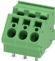
Leiterplattenklemme, Nennstrom: 32 A, Bemessungsspannung (III/2): 630 V, Nennquerschnitt: 4 mm<sup>2</sup>, Anzahl der Potenziale: 3, Anzahl der Reihen: 1, Polzahl pro Reihe: 3, Artikelfamilie: ZFKDS(A) 4, Rastermaß: 7,5 mm, Anschlussart: Zugfederanschluss, Montage: Wellenlöten, Anschlussrichtung Leiter/Platine: 45 °, Farbe: grün, Pin-Layout: Lineares Pinning, Pinlänge [P]: 4,6 mm, Anzahl der Lötpins pro Potenzial: 2, Verpackungsart: verpackt im Karton
