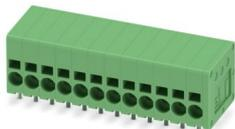
Leiterplattenklemme, Nennstrom: 17,5 A, Bemessungsspannung (III/2): 200 V, Nennquerschnitt: 1,5 mm<sup>2</sup>, Anzahl der Potenziale: 12, Anzahl der Reihen: 1, Polzahl pro Reihe: 12, Artikelfamilie: SPT 1,5/..-H, Rastermaß: 3,5 mm, Anschlussart: Push-in-Federanschluss, Montage: Wellenlöten, Anschlussrichtung Leiter/Platine: 0 °, Farbe: grün, Pin-Layout: Lineares Pinning, Pinlänge [P]: 2,5 mm, Anzahl der Löt pins pro Potenzial: 2, Verpackungsart: verpackt im Karton
