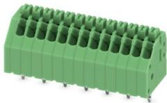
Leiterplattenklemme, Nennstrom: 2 A, Bemessungsspannung (III/2): 250 V, Nennquerschnitt: 0,5 mm<sup>2</sup>, Anzahl der Potentiale: 13, Anzahl der Reihen: 1, Polzahl pro Reihe: 13, Artikelfamilie: PTSA 0,5, Rastermaß: 2,5 mm, Anschlussart: Push-in-Federanschluss, Montage: Wellenlöten, Anschlussrichtung Leiter/Platine: 45 °, Farbe: grün, Pin-Layout: Zick-Zack-Pinning M, Pinlänge [P]: 3,6 mm, Anzahl der Lötpins pro Potenzial: 1, Verpackungsart: verpackt im Karton. Versetze Lötbeine, zweireihig
