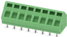
Leiterplattenklemme, Nennstrom: 16 A, Bemessungsspannung (III/2): 400 V, Nennquerschnitt: 1,5 mm<sup>2</sup>, Anzahl der Potenziale: 8, Anzahl der Reihen: 1, Polzahl pro Reihe: 8, Artikelfamilie: ZFKDS(A) 1,5C, Rastermaß: 5 mm, Anschlussart: Zugfederanschluss, Montage: Wellenlöten, Anschlussrichtung Leiter/Platine: 45 °, Farbe: grün, Pin-Layout: Lineares Pinning, Pinlänge [P]: 3,5 mm, Anzahl der Lötpins pro Potenzial: 2, Verpackungsart: verpackt im Karton
