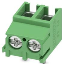
Leiterplattenklemme, Nennstrom: 32 A, Bemessungsspannung (III/2): 400 V, Nennquerschnitt: 2,5 mm<sup>2</sup>, Anzahl der Potentiale: 2, Anzahl der Reihen: 1, Polzahl pro Reihe: 2, Artikelfamilie: PT 2,5/..-V, Rastermaß: 5 mm, Anschlussart: Schraubanschluss mit Drahtschutzbügel, Montage: Wellenlöten, Anschlussrichtung Leiter/Platine: 90 °, Farbe: grün, Pin-Layout: Lineares Pinning, Pinlänge [P]: 4,1 mm, Anzahl der Lötpins pro Potenzial: 1, Verpackungsart: verpackt im Karton
