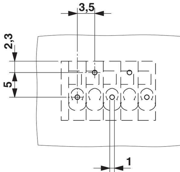
Abbildung zeigt den Bohrplan der 5-poligen Variante des Artikels - Zick-Zack Pinning beginnt am rechten Pol. Abweichendes Pinning auf Anfrage.
