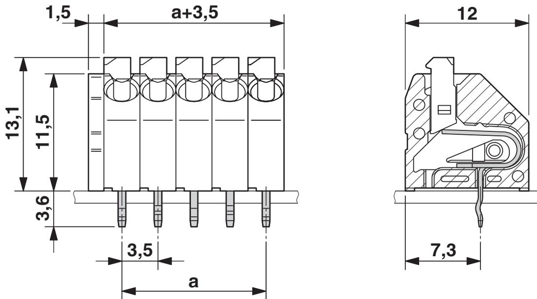
Abbildung zeigt die Maßzeichnung der 5-poligen Variante des Artikels
