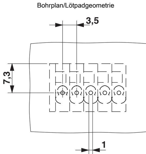
Abbildung zeigt den Bohrplan der 5-poligen Variante des Artikels
