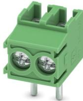
Leiterplattenklemme, Nennstrom: 17,5 A, Bemessungsspannung (III/2): 200 V, Nennquerschnitt: 1,5 mm<sup>2</sup>, Anzahl der Potenziale: 2, Anzahl der Reihen: 1, Polzahl pro Reihe: 2, Artikelfamilie: PT 1,5/..-V, Rastermaß: 3,5 mm, Anschlussart: Schraubanschluss mit Drahtschutzbügel, Montage: Wellenlöten, Anschlussrichtung Leiter/Platine: 90 °, Farbe: grün, Pin-Layout: Lineares Pinning, Pinlänge [P]: 4,5 mm, Anzahl der Lötpins pro Potenzial: 1, Verpackungsart: verpackt im Karton
