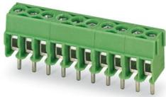
Leiterplattenklemme, Nennstrom: 17,5 A, Bemessungsspannung (III/2): 200 V, Nennquerschnitt: 1,5 mm<sup>2</sup>, Anzahl der Potenziale: 4, Anzahl der Reihen: 1, Polzahl pro Reihe: 4, Artikelfamilie: PT 1,5/..-H, Rastermaß: 3,5 mm, Anschlussart: Schraubanschluss mit Drahtschutzbügel, Montage: Wellenlöten, Anschlussrichtung Leiter/Platine: 0 °, Farbe: grün, Pin-Layout: Lineares Pinning, Pinlänge [P]: 4,5 mm, Anzahl der Löt pins pro Potenzial: 1, Verpackungsart: verpackt im Karton. CAT 5 geeignet
