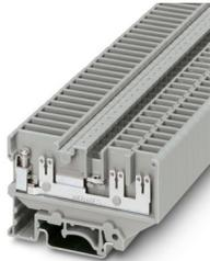
Durchgangsklemme, Nennspannung: 500 V, Nennstrom: 29 A, 1. Etage Anschluss links, Anschlussart: Schraubanschluss, Bemessungsquerschnitt: 4 mm<sup>2</sup>, Querschnitt: 0,2 mm<sup>2</sup> - 4 mm<sup>2</sup>, Anschlussart: Flachsteckanschluss, Montage: NS 35/7,5, NS 35/15, NS 32, Farbe: grau
