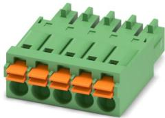
Leiterplattenstecker, Nennquerschnitt: 1,5 mm<sup>2</sup>, Farbe: grün, Nennstrom: 8 A, Bemessungsspannung (III/2): 160 V, Kontaktoberfläche: Sn, Kontaktart: Buchse, Anzahl der Potenziale: 5, Anzahl der Reihen: 1, Polzahl: 5, Anzahl der Anschlüsse: 5, Artikelfamilie: FMC 1,5/..-ST, Rastermaß: 3,5 mm, Anschlussart: Push-in-Federanschluss, Anschlussrichtung Leiter/Platine: 0 °, Stecksystem: COMBICON FMC 1,5 - MCDN 1,5, Verriegelung: ohne, Befestigungsart: ohne, Verpackungsart: verpackt im Karton
