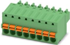
Leiterplattenstecker, Nennquerschnitt: 1,5 mm<sup>2</sup>, Farbe: grün, Nennstrom: 8 A, Bemessungsspannung (III/2): 160 V, Kontaktoberfläche: Sn, Kontaktart: Buchse, Anzahl der Potentiale: 8, Anzahl der Reihen: 1, Polzahl: 8, Anzahl der Anschlüsse: 8, Artikelfamilie: FK-MCP 1,5/..-ST, Rastermaß: 3,5 mm, Anschlussart: Push-in-Federanschluss, Anschlussrichtung Leiter/Platine: 0 °, Stecksystem: COMBICON MC 1,5, Verriegelung: ohne, Befestigungsart: ohne, Verpackungsart: verpackt im Karton
