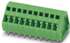
Leiterplattenklemme, Nennstrom: 12 A, Bemessungsspannung (III/2): 200 V, Nennquerschnitt: 1 mm<sup>2</sup>, Anzahl der Potentiale: 12, Anzahl der Reihen: 1, Polzahl pro Reihe: 12, Artikelfamilie: ZFKDS(A) 1, Rastermaß: 3,81 mm, Anschlussart: Zugfederanschluss, Montage: Wellenlöten, Anschlussrichtung Leiter/Platine: 45 °, Farbe: grün, Pin-Layout: Lineares Pinning, Pinlänge [P]: 3,5 mm, Anzahl der Lötpins pro Potenzial: 2, Verpackungsart: verpackt im Karton
