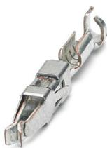
Buchsenkontakt, wird nach dem Ankrimpen des Leiters in das Steckerteil geschoben, für die Modulsteckergehäuse MCC 1...-STZ-3,81 und MCC 1...-STZF-3,81, für Querschnittsbereiche von 0,2 mm<sup>2</sup> bis 0,34 mm<sup>2</sup>
