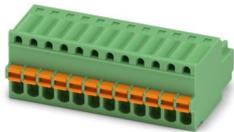
Leiterplattenstecker, Nennquerschnitt: 0,5 mm<sup>2</sup>, Farbe: grün, Nennstrom: 4 A, Bemessungsspannung (III/2): 160 V, Kontaktoberfläche: Au, Kontaktart: Buchse, Anzahl der Potenziale: 12, Anzahl der Reihen: 1, Polzahl: 12, Anzahl der Anschlüsse: 12, Artikelfamilie: FK-MC 0,5/..-ST, Rastermaß: 2,5 mm, Anschlussart: Push-in-Federanschluss, Anschlussrichtung Leiter/Platine: 0 °, Stecksystem: COMBICON FK-MC 0,5, Verriegelung: ohne, Befestigungsart: ohne, Verpackungsart: verpackt im Karton
