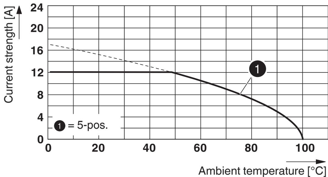
Derating-Kurve für: TMSTBP 2,5/...-STF-5,08 ABGY AU mit MSTBV 2,5/...-GF-5,08 ABGY AU
