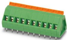
Leiterplattenklemme, Nennstrom: 16 A, Bemessungsspannung (III/2): 400 V, Nennquerschnitt: 1,5 mm<sup>2</sup>, Anzahl der Potenziale: 4, Anzahl der Reihen: 1, Polzahl pro Reihe: 4, Artikelfamilie: ZFKDS(A) 1,5-W, Rastermaß: 5,08 mm, Anschlussart: Zugfederanschluss, Montage: Wellenlöten, Anschlussrichtung Leiter/Platine: 45 °, Farbe: grün, Pin-Layout: Lineares Pinning, Pinlänge [P]: 3,5 mm, Anzahl der Lötpins pro Potenzial: 2, Verpackungsart: verpackt im Karton
