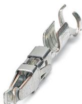
Buchsenkontakt, wird nach dem Ankrimpen des Leiters in das Steckerteil geschoben, für die Modulsteckergehäuse MCC 1...-STZ-3,81 und MCC 1...-STZF-3,81, für Querschnittsbereiche von 0,5 mm<sup>2</sup> bis 1 mm<sup>2</sup>
