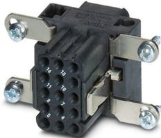
Kontakteinsatz, Artikelfamilie: VARIOCON, Bauform: VC1, Material Gehäuse: PA, Polzahl: 15, Aderquerschnitt min.: 0,14 mm<sup>2</sup>, Aderquerschnitt max.: 1,5 mm<sup>2</sup>, Bemessungsspannung: 250, Bemessungsstrom: 10 A, Anschlussart: Crimpanschluss, Steckverbinder dürfen nur leistungslos betätigt werden.
