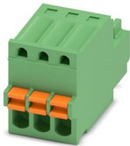
Leiterplattenstecker, Nennquerschnitt: 0,5 mm<sup>2</sup>, Farbe: grün, Nennstrom: 4 A, Bemessungsspannung (III/2): 160 V, Kontaktoberfläche: Sn, Kontaktart: Buchse, Anzahl der Potenziale: 3, Anzahl der Reihen: 1, Polzahl: 3, Anzahl der Anschlüsse: 3, Artikelfamilie: FK-MC 0,5/..-ST, Rastermaß: 2,5 mm, Anschlussart: Push-in-Federanschluss, Anschlussrichtung Leiter/Platine: 0 °, Stecksystem: COMBICON FK-MC 0,5, Verriegelung: ohne, Befestigungsart: ohne, Verpackungsart: verpackt im Karton
